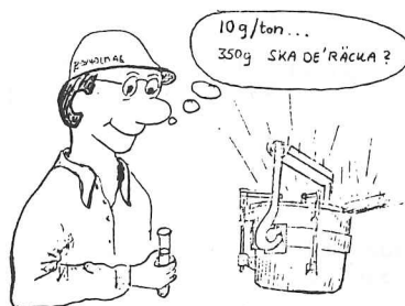
Bild 1. Bor sätter man till i gjutskänken i homeopatiska mängder. Bara ca 10 g/ton stål kan räcka.
