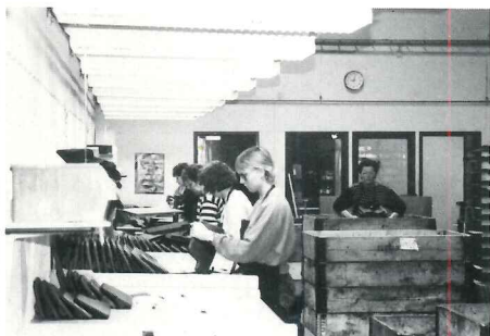
Avsugning, rengöring, putsning och packning av detaljerna görs manuellt.
