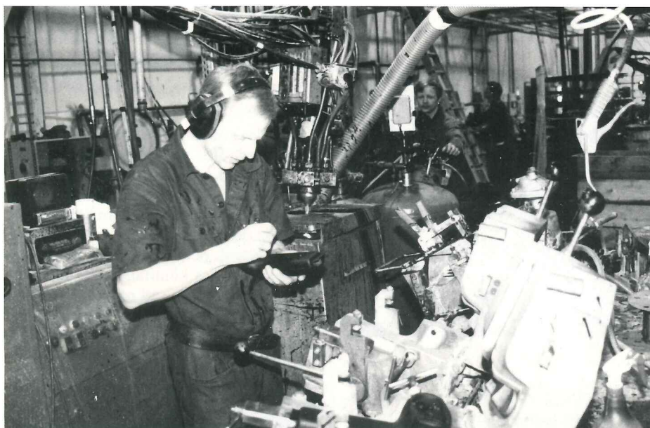
Sven-Inge Carlsson vid en av de fem integralsmaskiner som finns i produktionen. På karusellbordet finns plats för 17–20 verktyg. I verktygen placeras detaljens grundstomme av exempelvis metall. Verktyget fylls sedan med integralskum som snabbt jäser upp i formen. Efter ca 5 minuter är detaljen klar för urplockning. Arbetsuppgifterna utförs på ackord, baserat på antal verktyg, antal karusellvarv och kvalitet.
